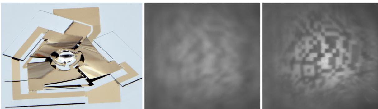
**Abbildung 42:** Links wird ein Foto eines Aktuatorverbunds mit abgeformter Mikrolinse gezeigt. In der Mitte und rechts sind die mittels CMOS-Sensor aufgenommenen Abbildungen eines QR-codes durch die Mikrolinse dargestellt. Deutlich sichtbar ist die Auswirkung der Verstellung der Mikrolinse auf die Schärfe der Abbildung.
